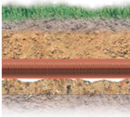
б) неправильно выполненное основание под трубой
